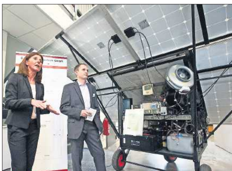
Sie ist fahrbar und autark: die Anlage der Firma G&M Systemtechnik, die aus Luft Wasser erzeugt. Geschäftsführerin Jutta Metzler und Geschäftsführer Norbert Götz stellen die Versuchsanlage vor.
